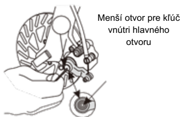
Obr. 14 – Nastavenie brzdových platničiek
