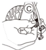
Obr. 15 – Nastavenie brzdových platničiek
